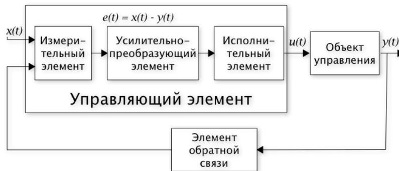
Рис. 4. Система управления, работающая по отклонению
