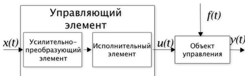
Рис. 2. Система управления, работающая по разомкнутому (или открытому) циклу
