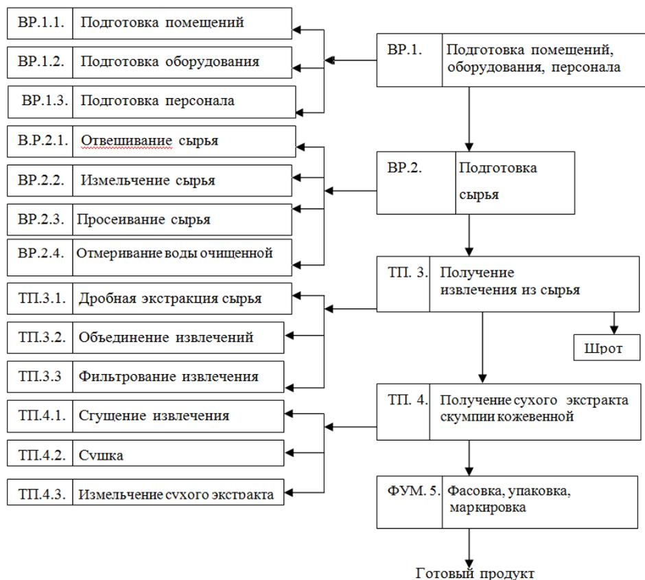
Рис. 1. Технологическая схема получения сухого экстракта скумпии кожевенной
